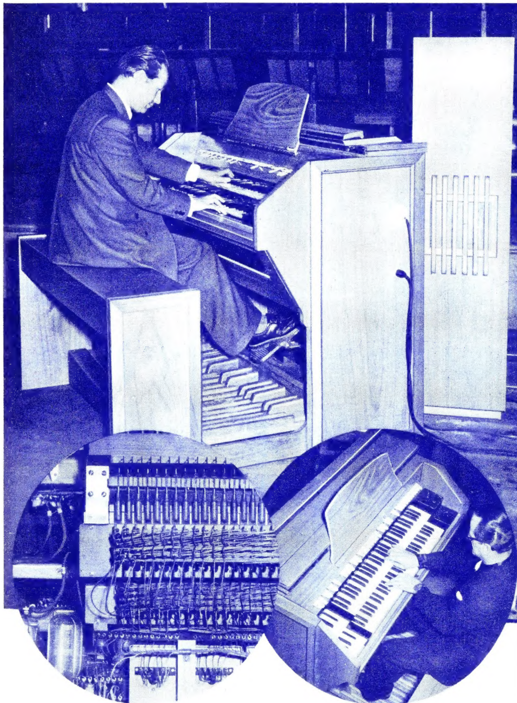
Harald Bode, einer der bekanntesten Fachleute auf dem Gebiet der elektrischen Musik, führt seine neue Elektronenorgel „Polychord“ vor. Der Spieltisch und die Klangmöglichkeiten entsprechen vollkommen einer normalen Pfeifenorgel, die Konstruktion sichert eine wirtschaftliche Herstellung, so daß große Absatzmöglichkeiten, besonders im Export, bestehen. — Links unten ein Teil der Kreuzschienenverteiler zur Synthese der verschiedenen Klangfarben. (Aufnahme: C. Stumpf)
